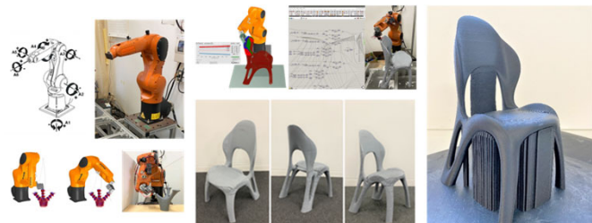
一般的な3Dプリンタで造形した椅子 ⇒大量のサポート材を使用している
