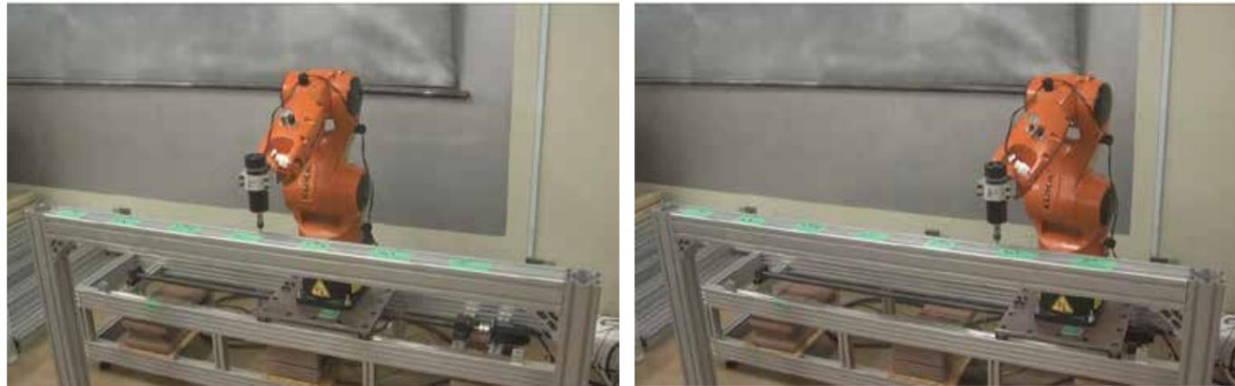
一軸走行台によってロボットを移動し、ロボットの加工範囲を拡大します。
