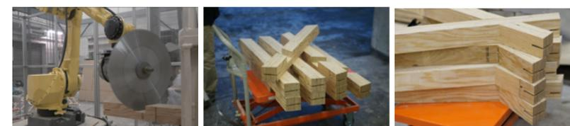
脚部の部品加工は大断面のため、六軸腕型ロボットを用いた。ドーム本体と脚部の接続にも同様に3Dプリンタによるコネクタを用いた。
