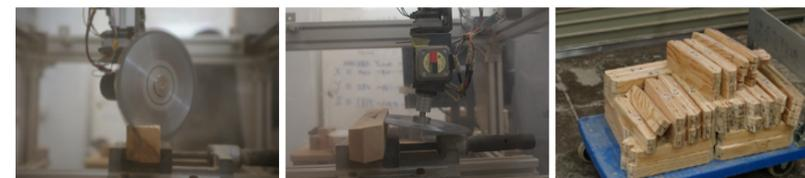
ドーム本体部の部品には高い精度が求められるため、五軸加工機によって加工を行った。数値制御の多軸加工機により、人力作業では困難な部品毎に異なる留めの形状及び山切りを設定して部材を配置する。
