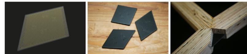
部品の接合の際の補強として、カーボンファイバーによって強化したコネクタを3Dプリンタで出力して用いた。表面に部品番号を彫りこむことで部品管理を容易にした。
